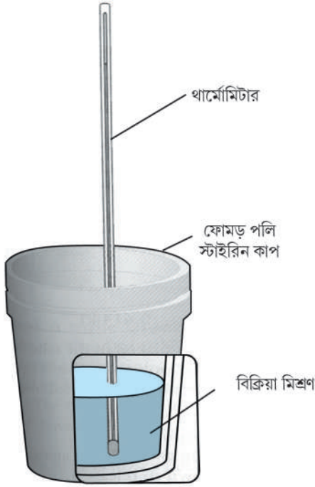
চিত্র : 6.8 স্থিরচাপে (বায়ুমন্ডলীয় চাপে) তাপ-পরিবর্তন নির্ণয়ের জন্য ব্যবহৃত ক্যালোরিমিটার।
